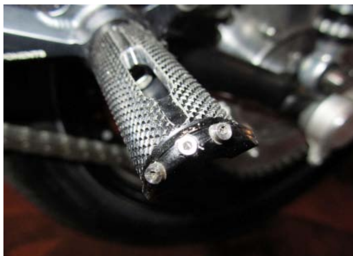
Abgeschliffene M2-Schraubchen an der Raste bieten Halt für den Fuss beim Betätigen der Fersenschaltung.
