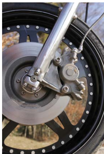
Bremsen von AP Lockheed. Einst das Non-plus-ultra. Genietetes Verbundrad.
